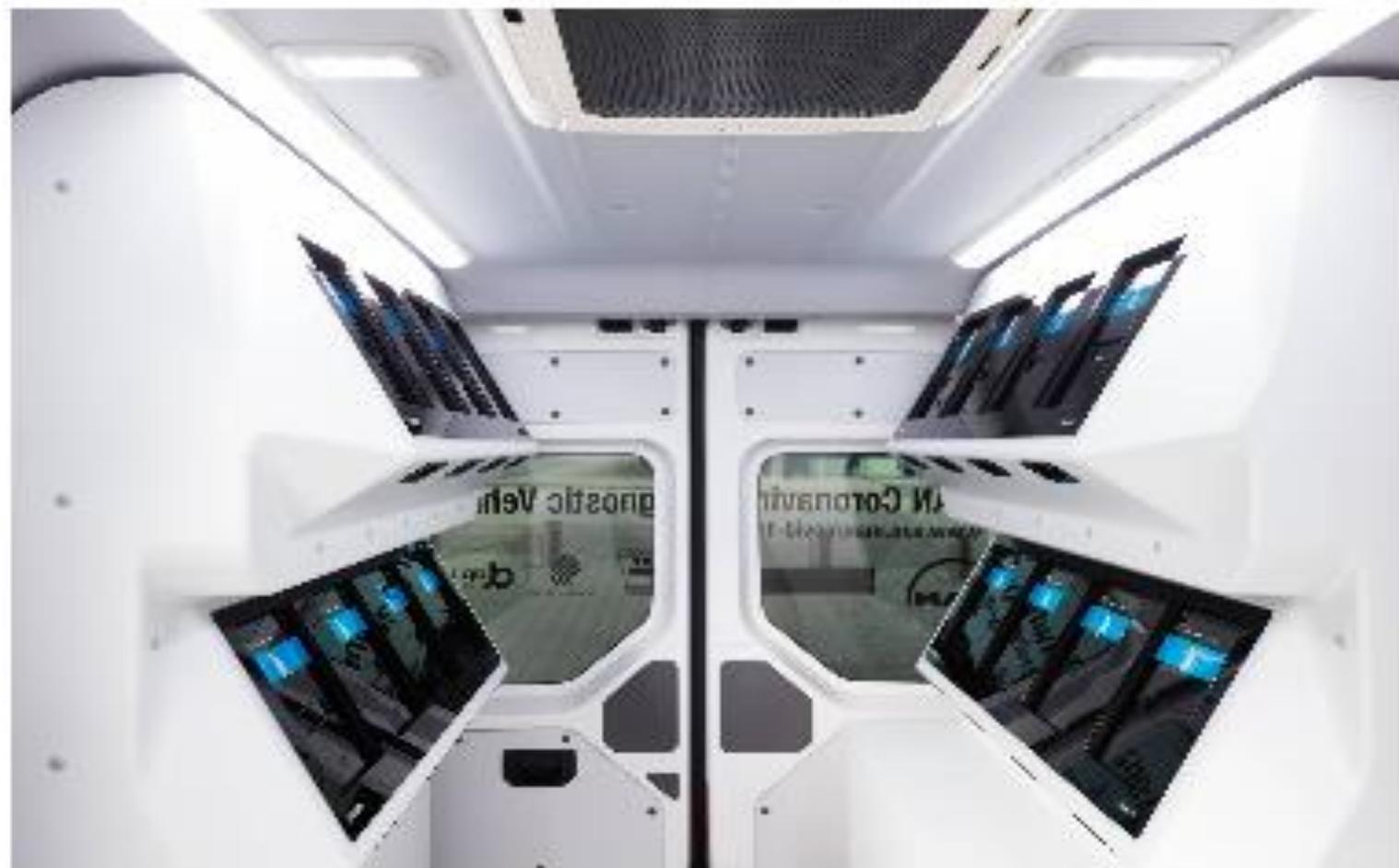
Mit den molekulardiagnostischen PCR-Testgeräte Vivalytic von Bosch Healthcare Solutions an Bord des MAN TGE liegen die Testergebnisse innerhalb von 39 Minuten vor.
