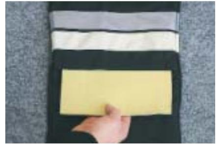
die Bayern 2000 Schutzanzug-Latzhose getragen werden. Wichtig dabei ist das Einbringen von 210 mm breiten und 250 mm langen und mindestens 5 mm starken Paraaramid (z.B. Kevlar)-Platten. Diese Protektoren bieten den notwendigen Schutz vor Strahlungs- und Boden-Kontakthitze im Kniebereich. Der übrige geringe verbleibende, nicht zusätzlich isolierte, Bereich der Latzhosen wurde als Hitzefenster definiert.
