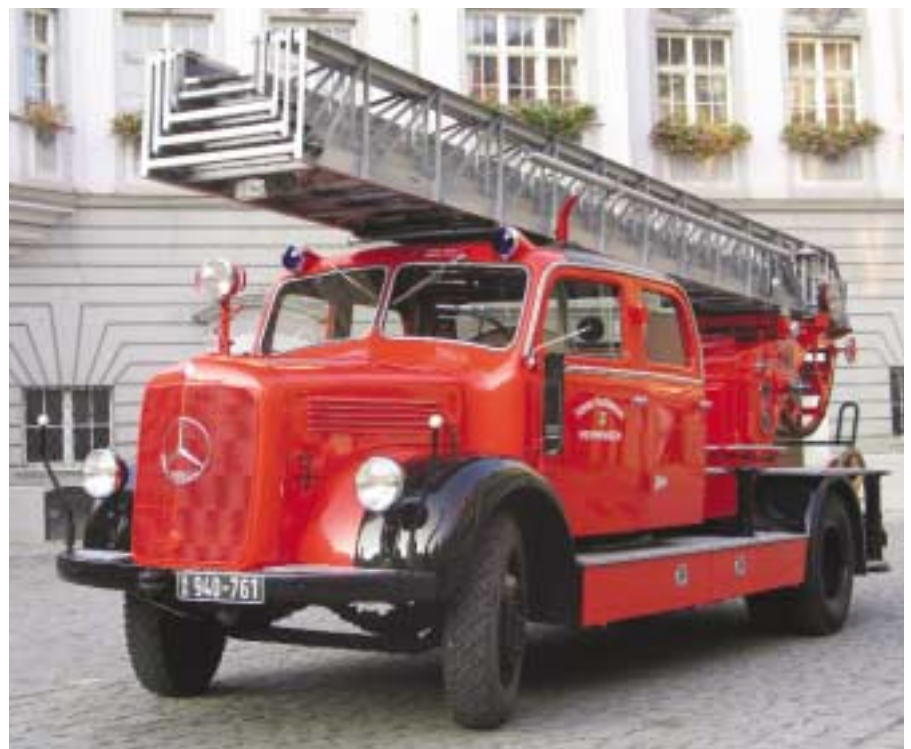
50 Jahre alt ist die von der Interessengemeinschaft alter Memminger Feuerwehrfahrzeuge liebevoll gepflegte DL 25 auf Fahrgestell Mercedes-Benz LF 3500 mit einem Leiteraufbau der Fa. Metz.
