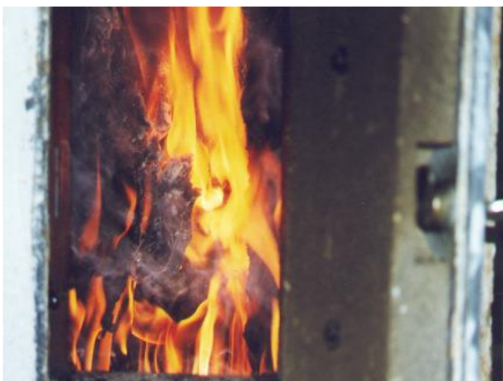
Bild 4 und Bild 5 : Rußbrand im Kamin bei geöffneter Reinigungstür
