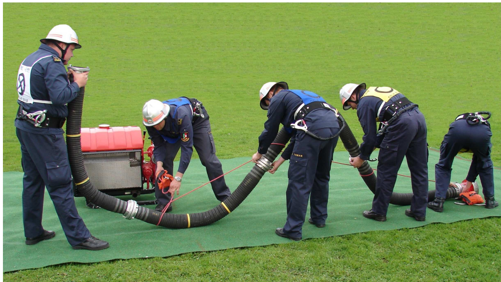
Abb.12: Tragen der Saugschlauchleitung Richtung Wasserentnahmestelle
