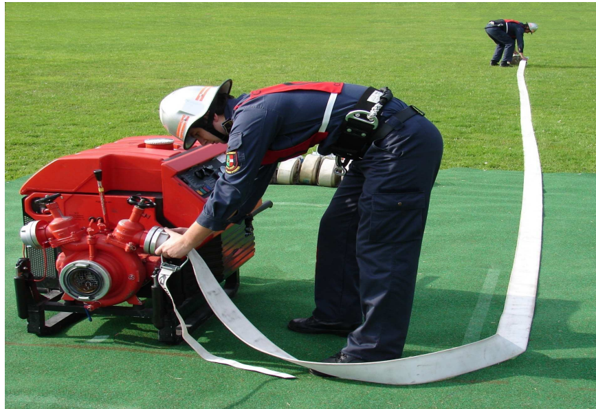
Abb.17: Ankuppeln und Auslegen des ersten B- Schlauches
