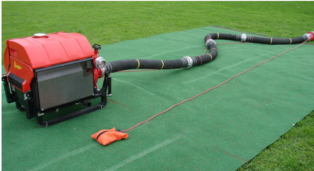
Abb. 15.: Ablegen des Leinenbeutels mit der Ventilleine
