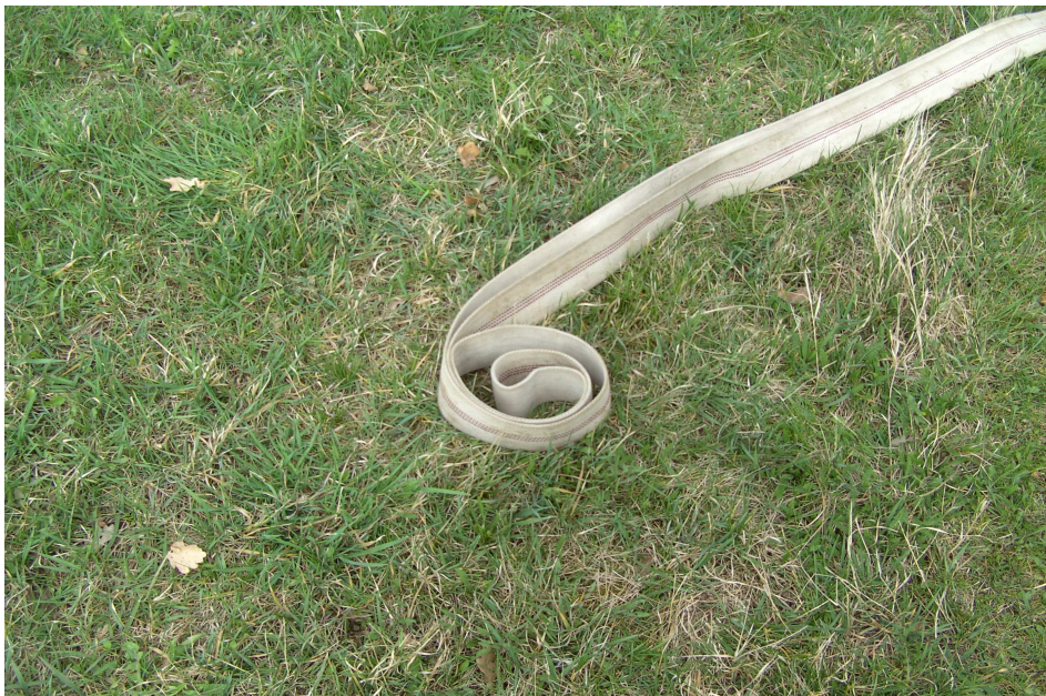
Abb. 21b Schlecht ausgelegter Druckschlauch „Schnecke“
