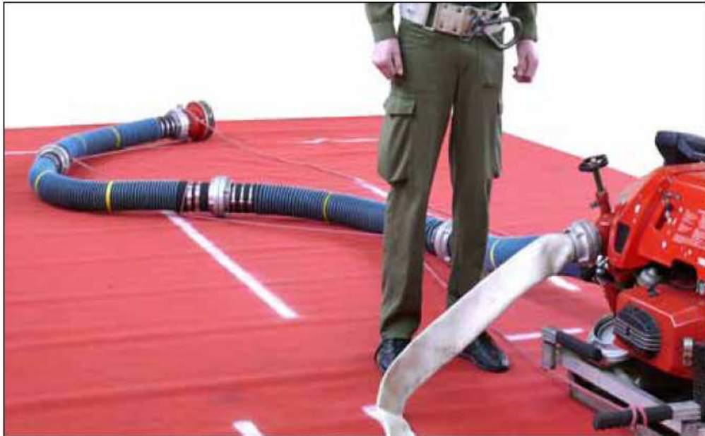
Abb. 16: Befestigen Saugschlauchleine an der TS
