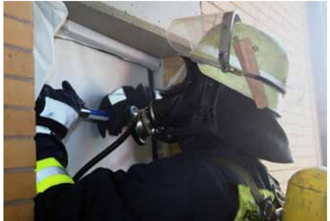
Bildunterschrift: Mobiler Rauchverschluss mit wenigen Handgriffen montiert
