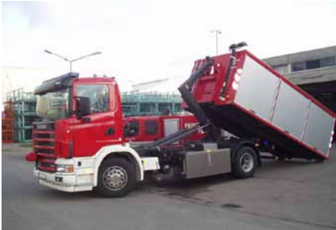
Bildunterschrift: Wechsellader-Fahrzeug mit Abrollbehälter
